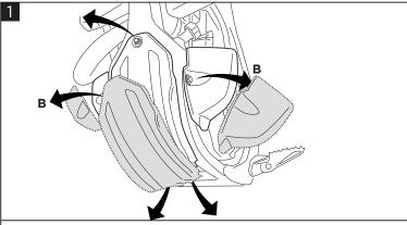
Remove the original skid plate and side protectors. Rimuovere il sottomotore e le protezioni laterali originali.
